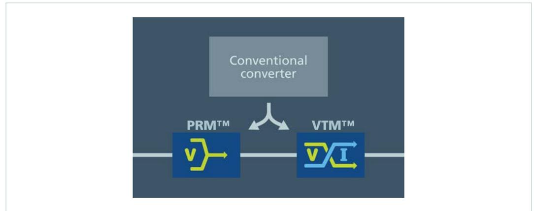
高密度电流倍增器模块 (VTM 或 MCM) 可布置在非常靠近处理器的位置，可以在处理器旁边，也可以在处理器正下方，将电源垂直提供给上面的处理器电源引脚。在 1000 安培的电流下，1μΩ 的 PDN 电阻相当于 1W 的功耗。使用传统多相同步降压 VR 产生的典型 PDN 电阻，会带来 200μΩ 的 PDN 电阻，相当于 200W 的功耗，这可导致无法接受的系统性能。采用 Vicor 电流倍增器实现的横向供电或垂直供电可将 PDN 电阻分别降至 50μΩ 和 5μΩ。
