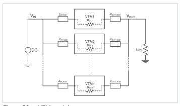
Figure 20 — VTM module array
